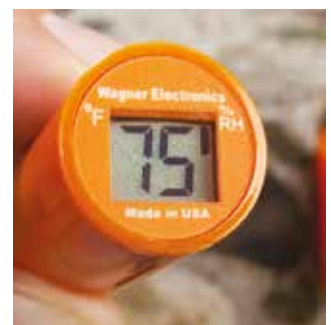
Der RH-Test (relative Betonluftfeuchte)
